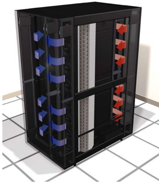
図3 – 完全にラック内部を冷却するラック冷却ソリューション
